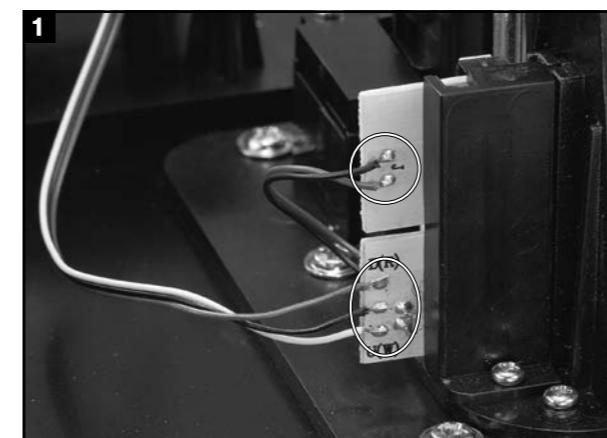
昇降装置のリミットスイッチのコードが断線していないか確認しよう。
