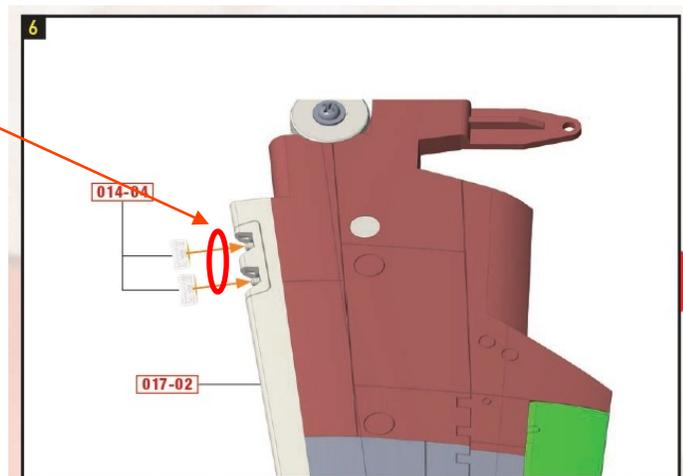
第14号に付属していたライトカバー [014-04] 2個の側面に少量の多用途接着剤を塗り、主翼(左)前縁 [017-02] に接着する。接着剤がはみ出さないように注意。
