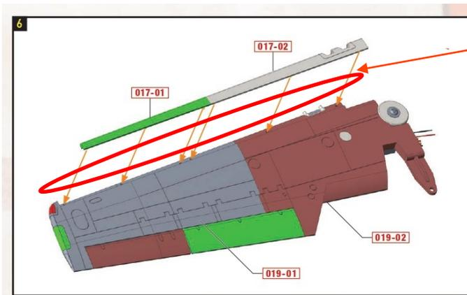
第17号に付属していた主翼(左)前縁 [017-01] と主翼(左)前縁 [017-02] の裏側にあるピンに多用途接着剤を塗り、主翼(左)上面 [019-01] と主翼(左)上面 [019-02] に接着する。
